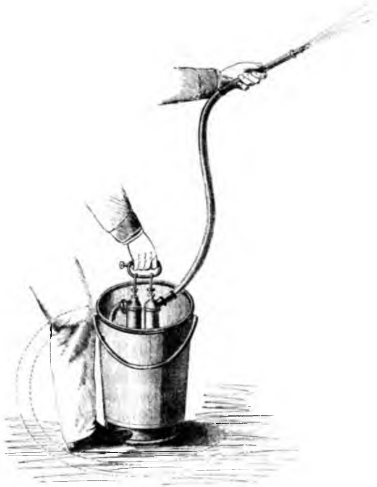
Рис. 24. Садовая спрыцовка средних размѣровъ.
